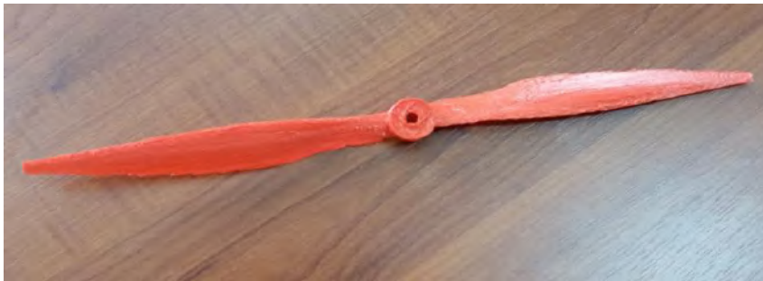
Şekil 14. 3B yazıcı ile üretilen pervane
