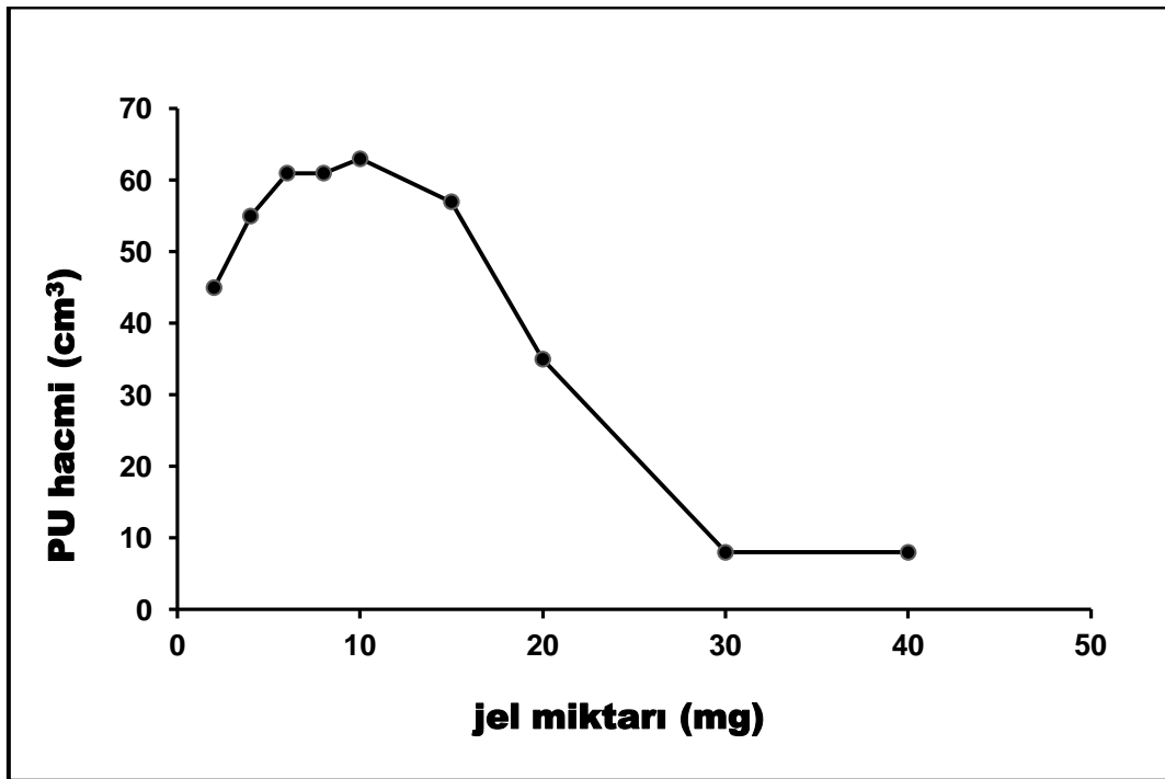
Şekil 6. Poli [2(Dietil amino)etil akrilat] hidrojelinin miktarlarına bağlı olarak elde edilen PU hacmi (TEA için elde edilen hacim 36 cm 3 ).
